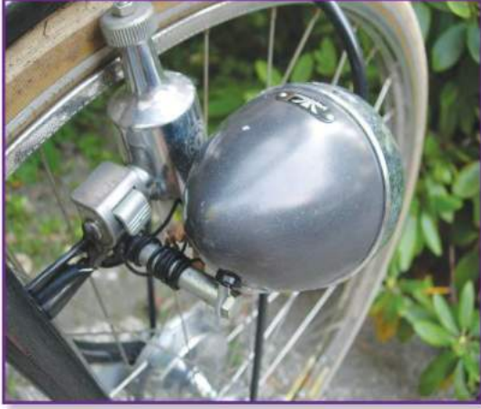
يتصل المولد الكهربائي بعجلة الدراجة
